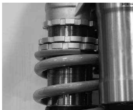
(A). Écrou (B). Ressort. (C). Contre-écrou.
